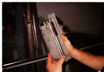
De Y-as van de X-, Y-, Z-besturing
